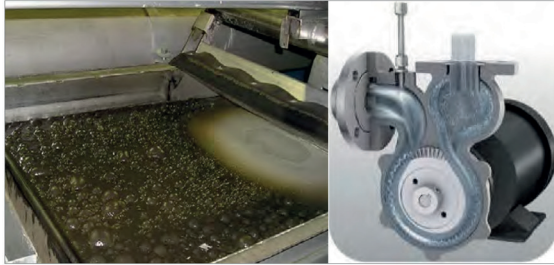
Şekil 4. Mikroflotasyon sistemi ve pompası (8)
