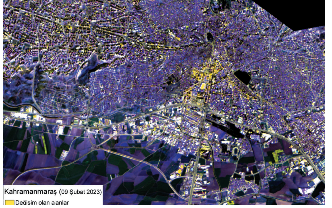
Şekil 6. Kahramanmaraş ili için deprem öncesi ve deprem sonrası Sentinel-2 verilerinden elde edilen yapay renkli görüntü.
