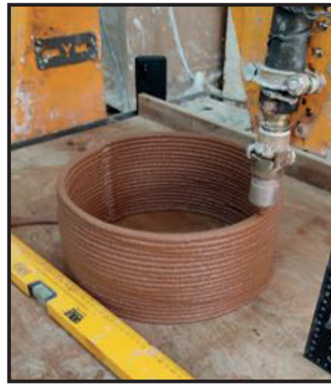
Şekil 17. İYA-bazlı jeopolymer beton ile üretilmiş 3B-Eİ ile gerçekleştirilen tasarımlar
